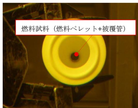
B. 燃料溶解前の燃料試料外観
