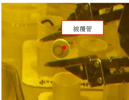
E. 燃料溶解後の被覆管外観 (洗浄後)
