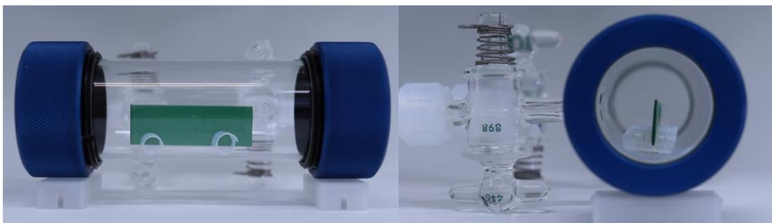
図 3.3 Ru 沈着試験装置の概略図 (材料検体：エポキシ塗料)
