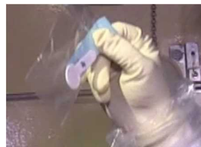
原子炉建屋壁面をふき取ったろ紙
