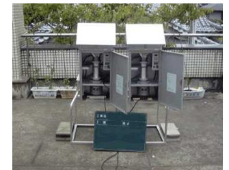
浮遊じんの測定
