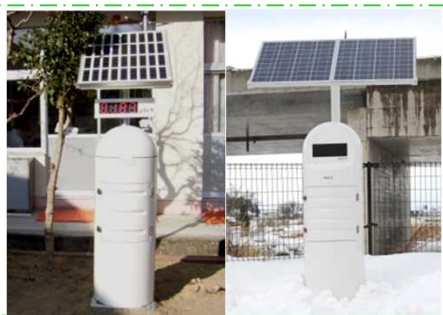
リアルタイム線量測定システム
