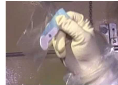
原子炉建屋壁面をふき取ったろ紙
