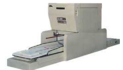
ホールボディカウンタ等設備整備
