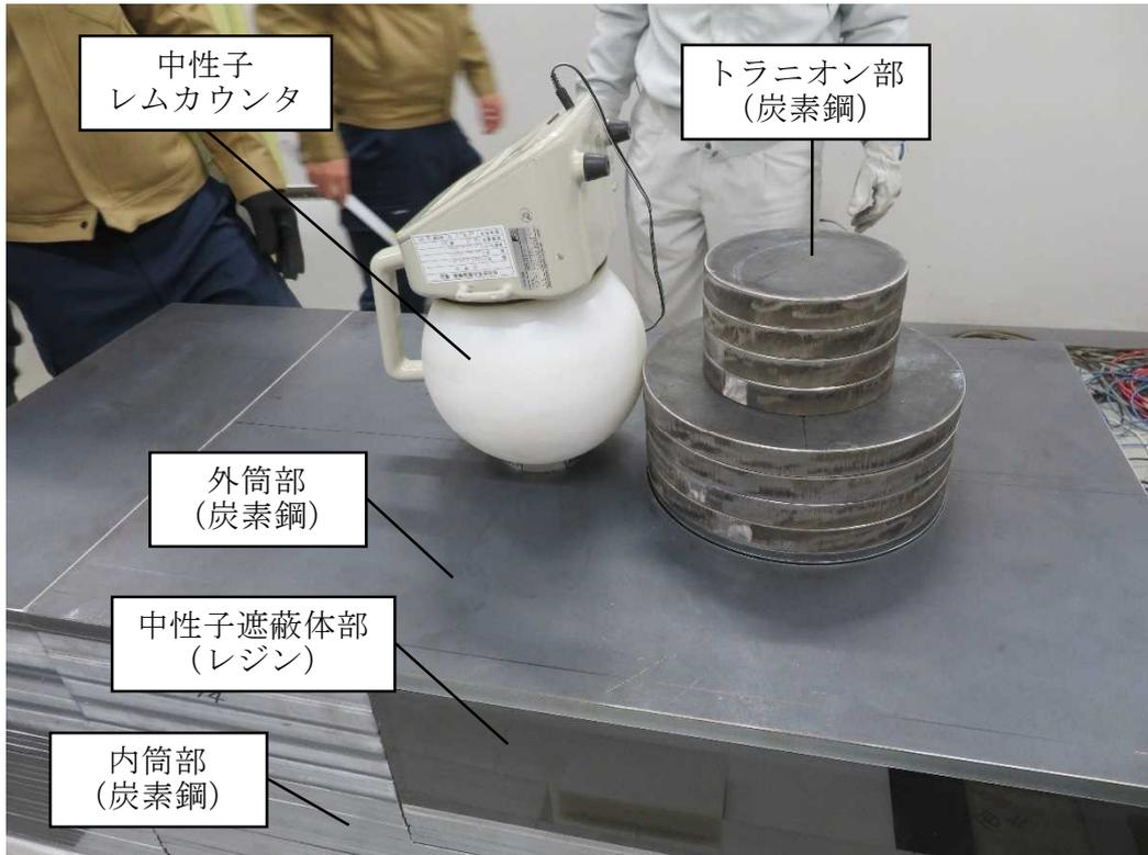
図 2.1.3.5 トランニオン部モックアップを用いた実験装置の配置
