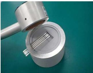
図2 密封線源健全性検査
