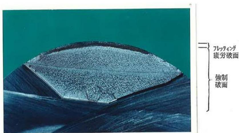
図 7 フレット疲労破面例
