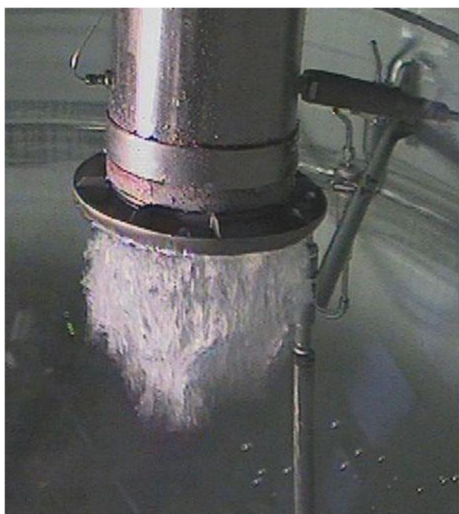
図参考 7-4-2 蒸気凝縮試験の様子
