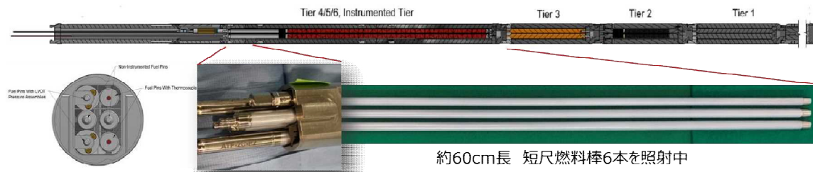
米国の照射試験炉で照射中のクロムコーティングジルカロイ被覆管の試験体
