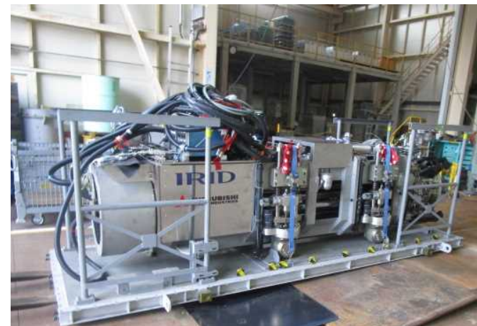
堆積物除去装置 (高圧水・AWJ) 外観
