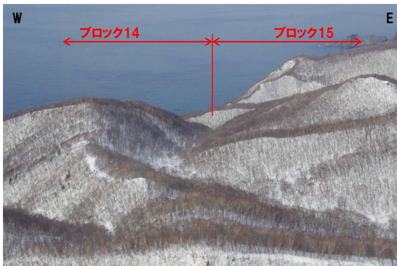
写真8:ブロック14・15境界 (防災科学技術研究所 (2010) のブロック10) ブロック境界は、植生のある独立した山地状の尾根に挟まれる開析された沢で、防災科学技術研究所 (2010) で記載される逆向き崖や低崖は認められない。
