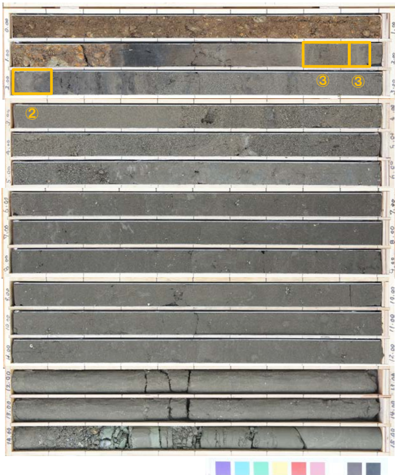
ボーリングコア写真(堀株川右岸) 孔口標高 1.74m 抽出範囲
