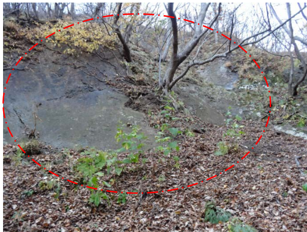
OP2: 左岸に分布する神恵内層の自破碎溶岩。
