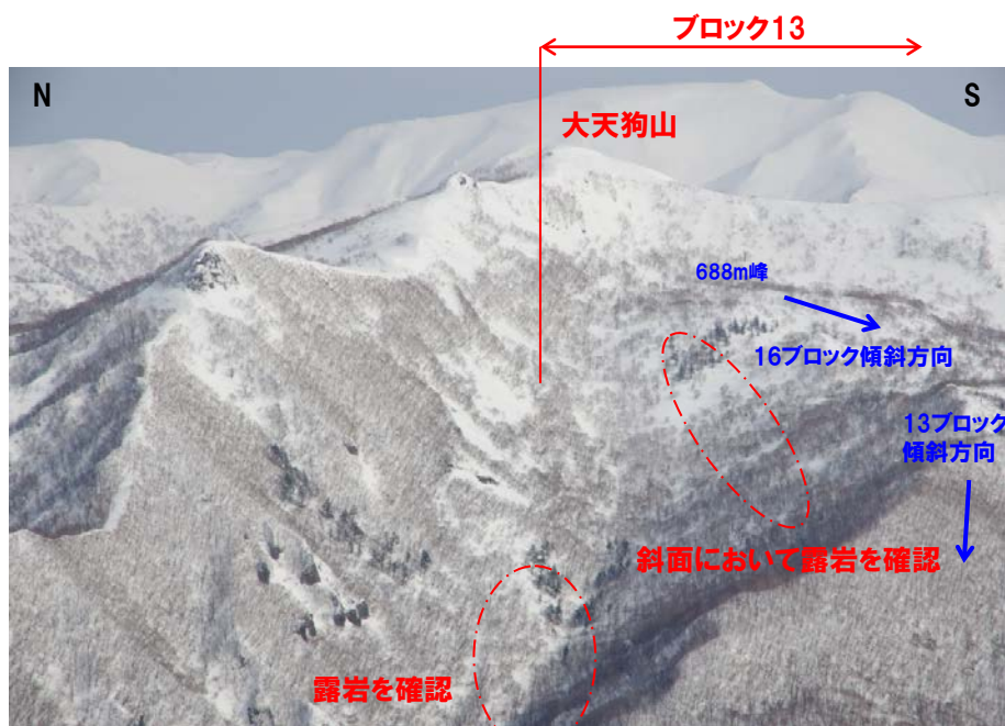
写真2: オブカルイシ川下流からブロック13 (防災科学技術研究所 (2010) のブロック9) ブロック境界にあたるオブカルイシ川河床には、連続して露岩が確認されている。防災科学技術研究所 (2010) ではブロック13は明瞭な地すべり土塊で記載されているが、両岸斜面は開析され、斜面勾配も緩い。
