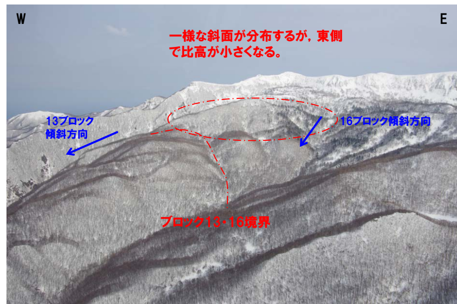
写真3: ブロック13・16境界 (防災科学技術研究所 (2010) のブロック9・11) 防災科学技術研究所 (2010) の滑落崖位置には斜面が認められることから、樹枝状を呈する沢から尾根の鞍部を境界とした。
