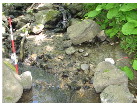
写真14: 河床に分布するよく締まった礫層。
