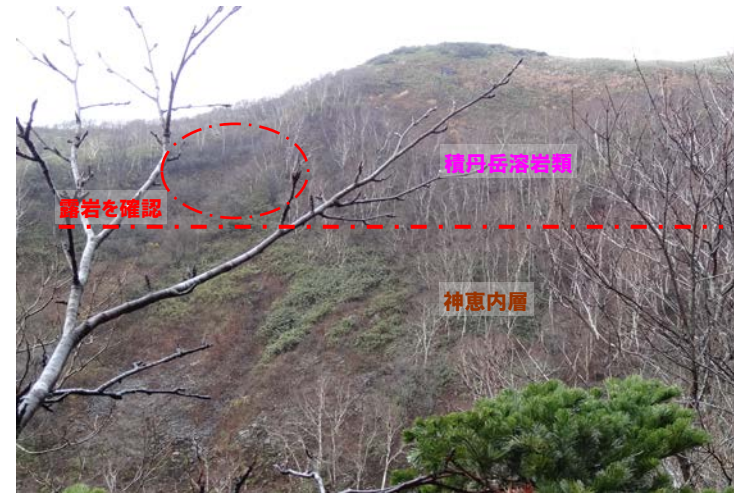
OP18: 山頂及び斜面の露頭で積丹岳溶岩、河床付近では神恵内層を確認。
