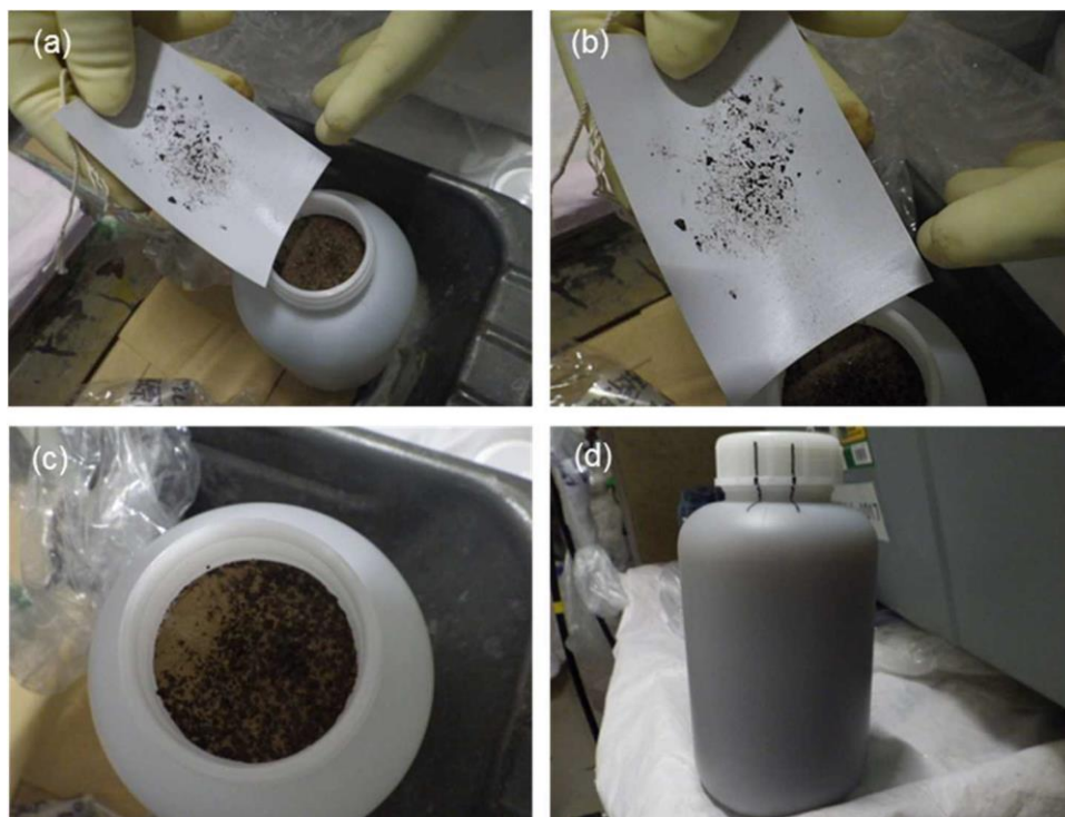
堆積物を純水に投入し抽出水を製作した際の状況
