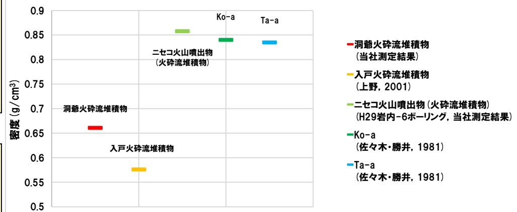
各火砕流堆積物に含まれる軽石の密度 (当社測定結果、上野(2001)及び佐々木・勝井(1981)を基に作成)
