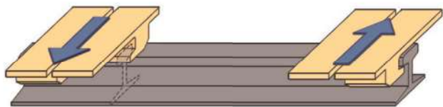
(b) 走行脱線防止装置の挙動と走行レールの位置関係イメージ
