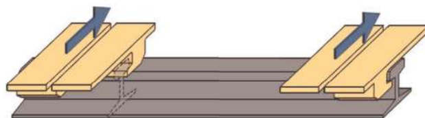
(b) 走行脱線防止装置の挙動と走行レールの位置関係イメージ
