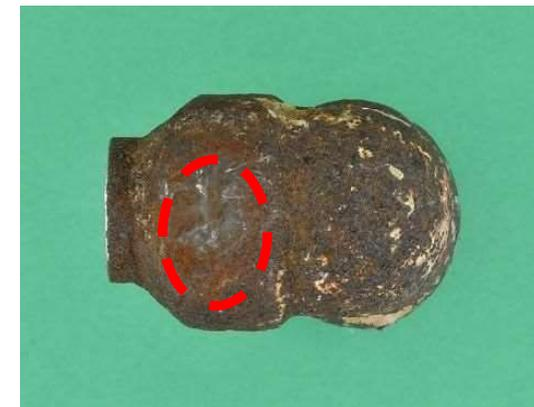
図2 ベント管のエルボ頂部の圧痕
