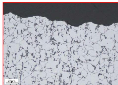
き裂部の断面ミクロ観察結果
