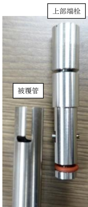
図補 4-1 燃料試料挿入管（試作品）の上部外観
