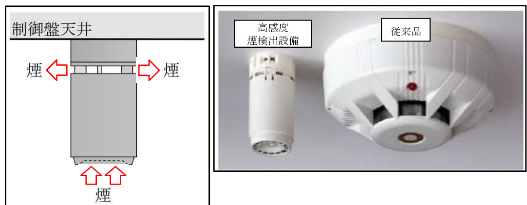
第 3-13 図 高感度煙検出設備の概要
