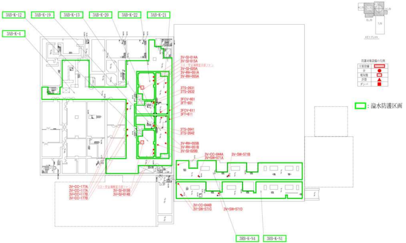
泊発電所3号炉 内部溢水防護対象設備配置図(10/12) T. P. 2. 3m
