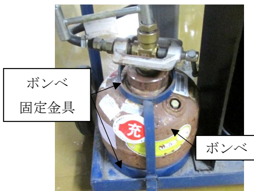
【技能訓練施設技能訓練棟】 アセチレンボンベ
