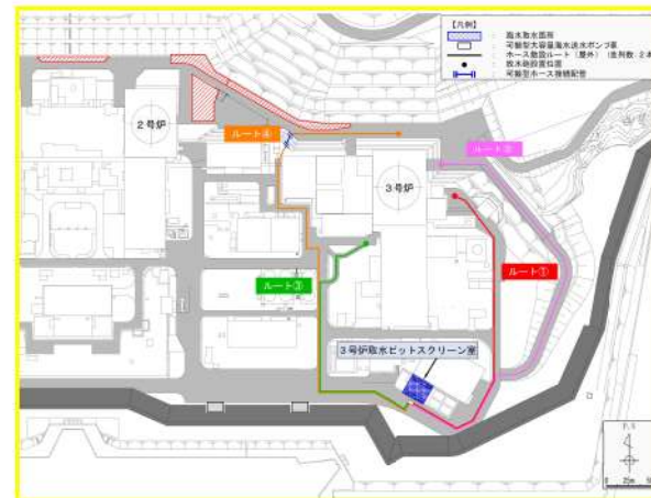
第5図 ホース敷設ルート（放射性物質拡散抑制）(1/2)
