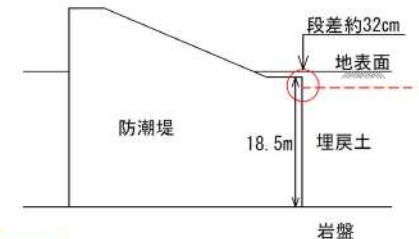
図7-16 許容段差15cmを超える段差発生が想定される箇所 (図7-14 No.55, 56, 57)
