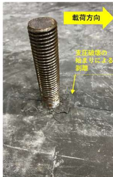
第 7-77 図 せん断試験後の状況写真（破壊形式確認ケース）
