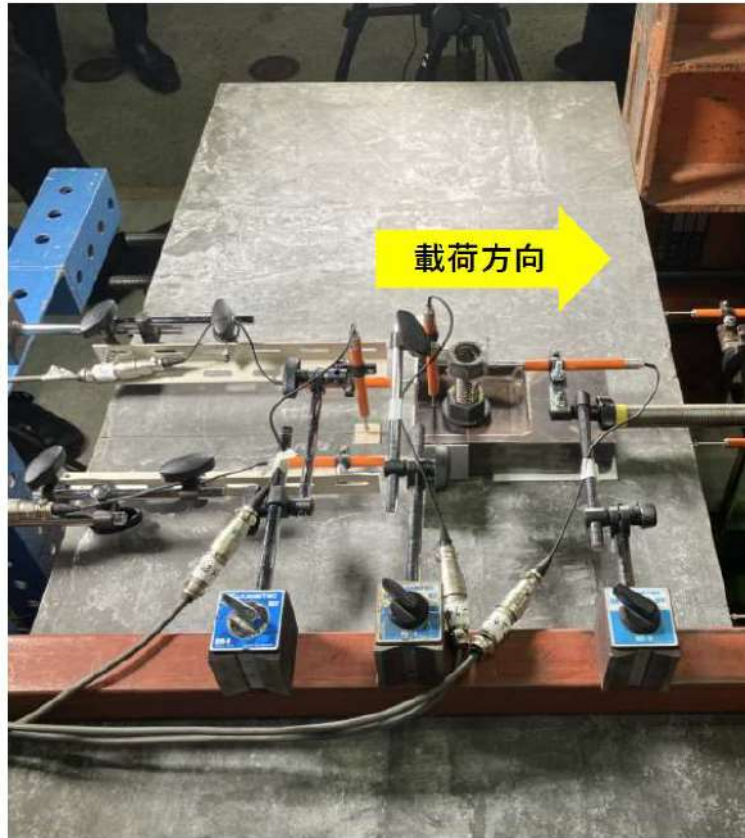
第 7-76 図 せん断試験最大荷重载荷後の状況写真（破壊形式確認ケース）
