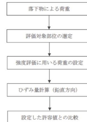
図5-4 燃料集合体の強度評価フロー
