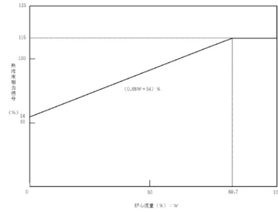
図3-3 中性子束高一自動可変設定（熱流束相当）のスクラム設定値
