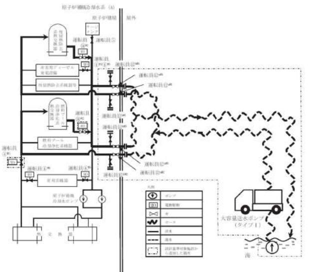
第1.5-28図 大容量送水ポンプ（タイプI）による補機冷却水確保 概要図（1/2）
