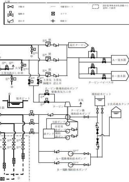
第1.5.5図 可搬型大型送水ポンプ車を用いた蒸気発生器2次側のフィードアンドブリード 概要図(1/2)
