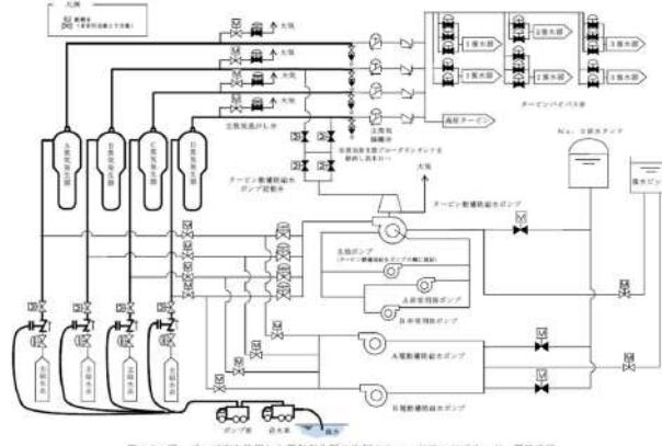
第1.5-4図 ポンプ車を使用した蒸気発生器次側のフィードアンドブリード 概要図
