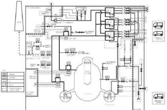
第1.5-4図 原子炉格納容器フィルタ・エント系による原子炉格納容器内の減圧及び除熱（現地操作含む） 概要図（1/2）
