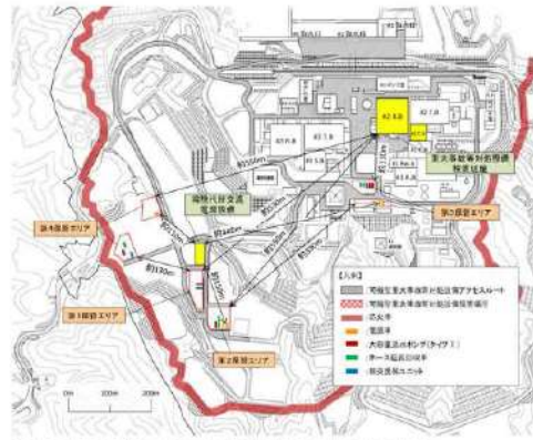
第2図 「2n+a」の可搬型設備配置
