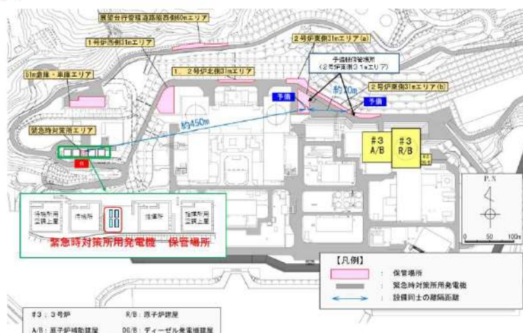
図4-10 緊急時対策所用発電機の保管場所
