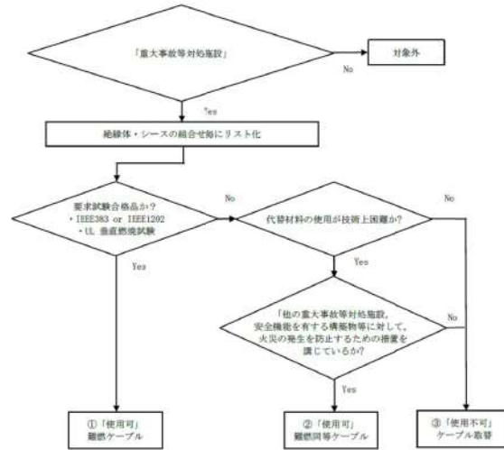
第1図：難燃性ケーブル確認方法
