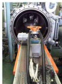
図2 蒸気曝露試験装置
