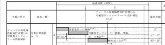
図 2.14.43 代替所内電気設備による交流の給電（可搬型代替電源車）のタイムチャート*
