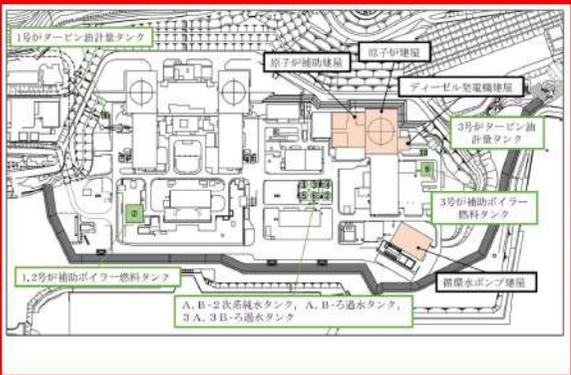
図12-1 溢水影響評価の対象となる屋外タンクの配置図
