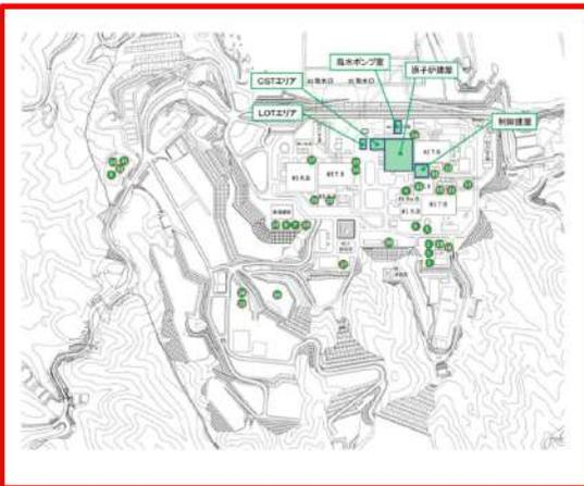
図13-1 溢水影響評価の対象となる屋外タンクの配置図
