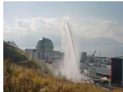
第10図 直状放射による放水状況
