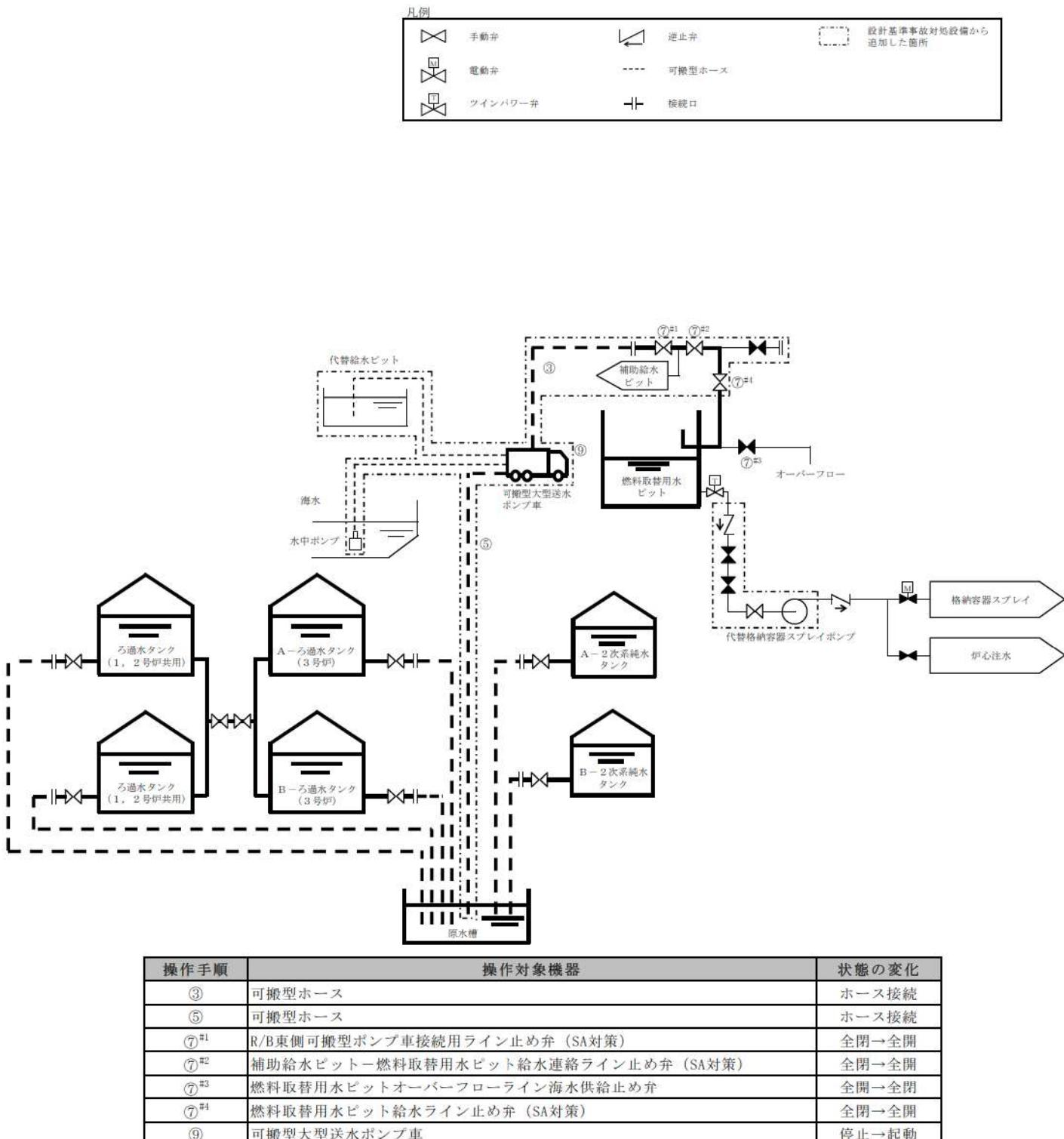
第 1.13.2 図 原水槽を水源とした可搬型大型送水ポンプ車による
