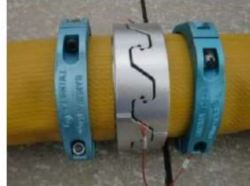
可搬型ホース（150A）接続後
