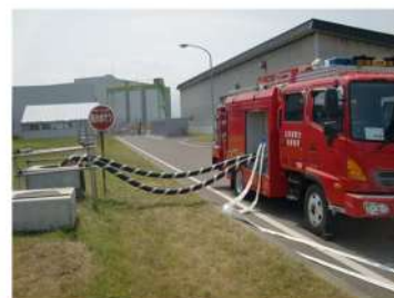
水源への吸管挿入 (屋外)
