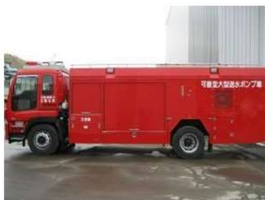
可搬型大型送水ポンプ車
