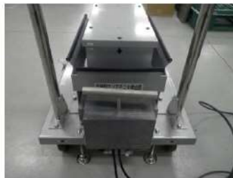
可搬型エリアモニタ 検出器側
