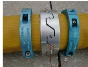
可搬型ホース（150A）接続後
