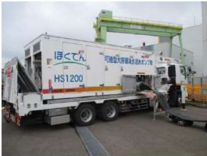
可搬型大容量海水送水ポンプ車の設置(屋外)
