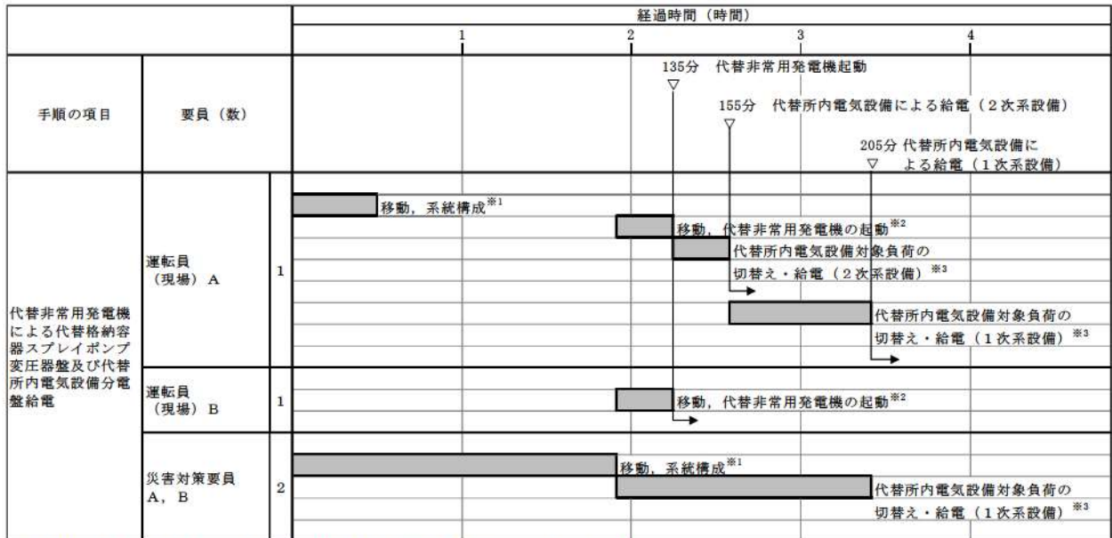
図2 代替所内電気設備による交流の給電（代替非常用発電機） タイムチャート
