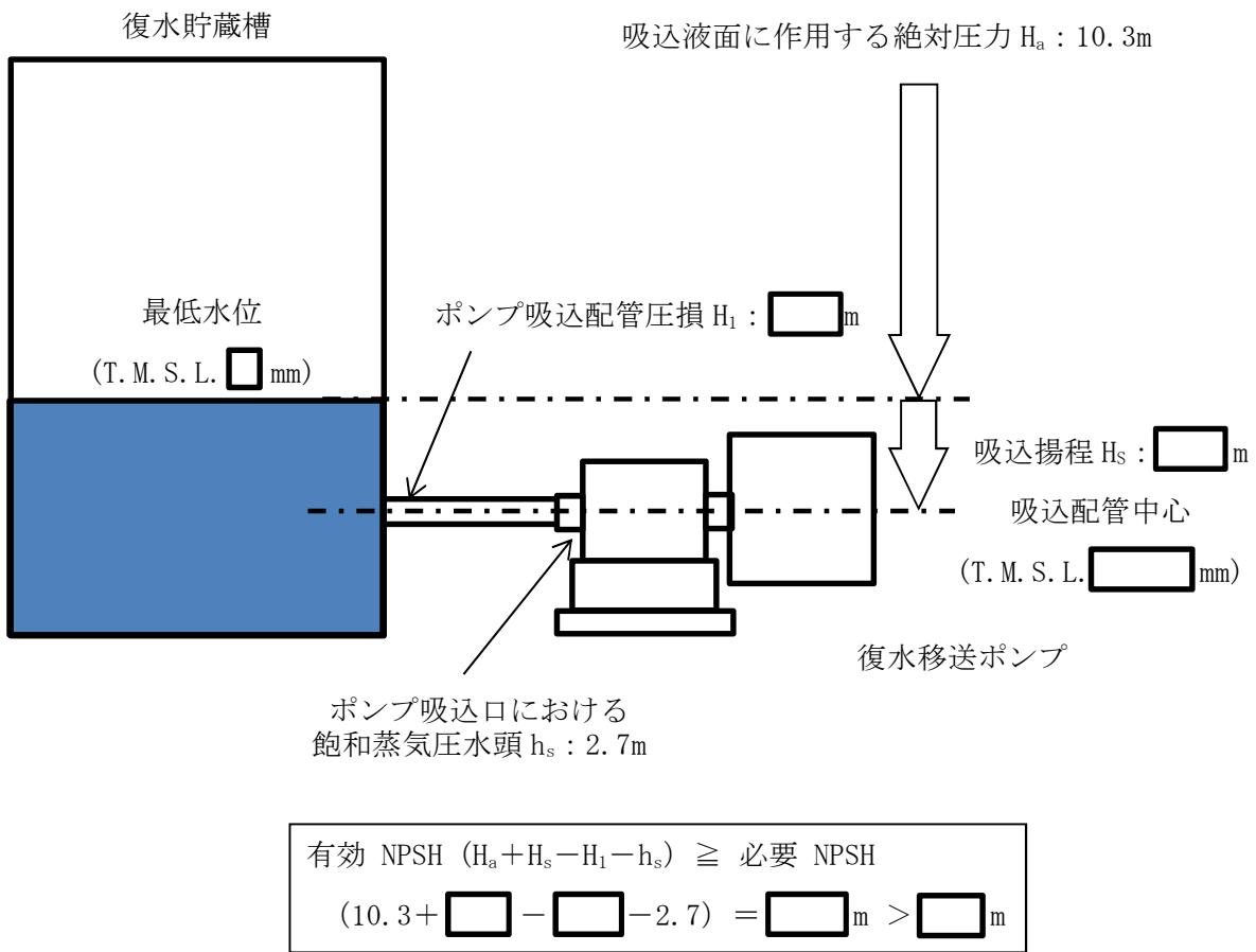
図 3-2 復水移送ポンプの有効 NPSH 評価の概略図
