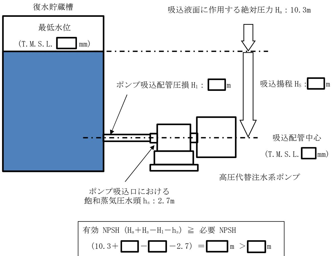
図 3-1 高圧代替注水系ポンプの有効 NPSH 評価の概略図
