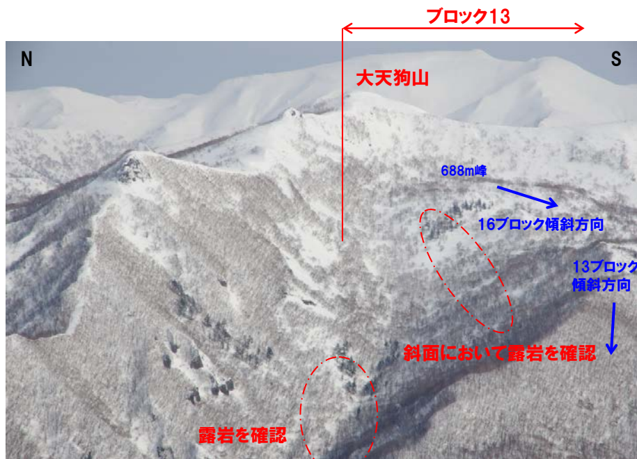
写真2: オブカルイシ川下流からブロック13 (地すべり地形DBブロック9) ブロック境界にあたるオブカルイシ川河床には、連続して露岩が確認されている。 地すべり地形DBではブロック13は明瞭な地すべり土塊で記載されているが、両岸斜面は開析され、斜面勾配も緩い。
