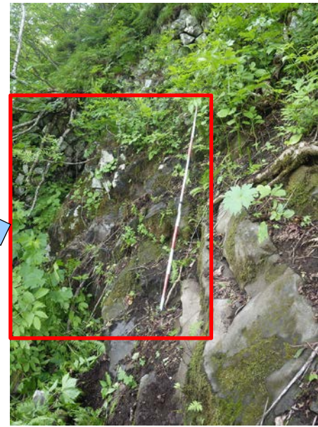
OB24: オブカルイシ川左岸斜面, 標高440m付近。 柱状節理の発達した積丹岳溶岩類の塊状溶岩類。
