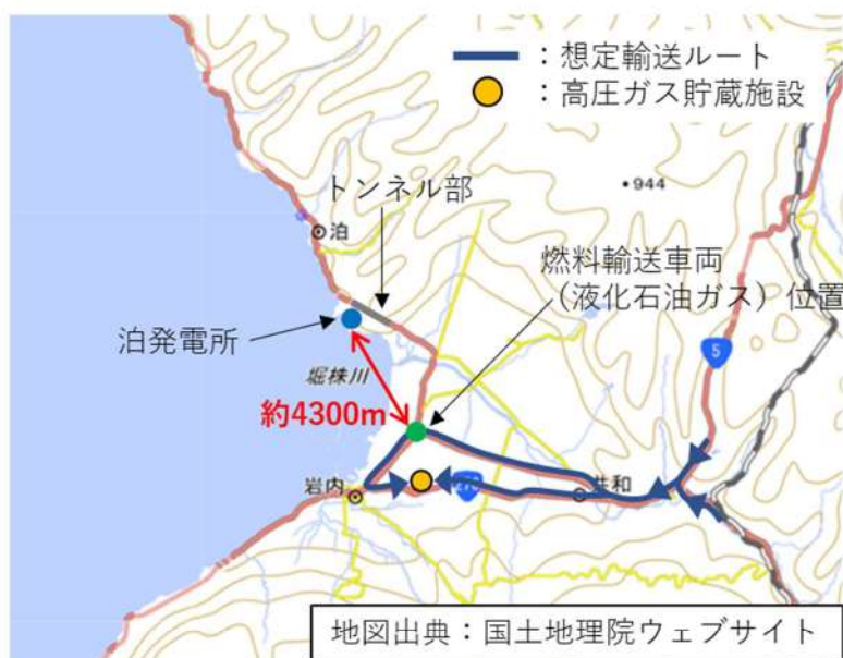
第 4-7 図 高圧ガス輸送車両爆発想定位置と発電用原子炉施設との位置関係
