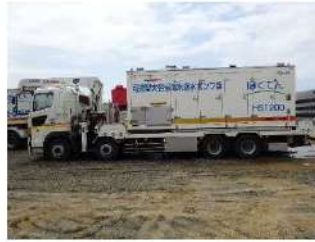
可搬型大容量海水送水ポンプ車
