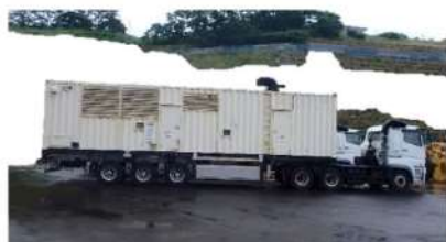
可搬型代替電源車
