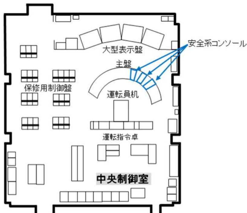
第1図 中央制御室配置図
