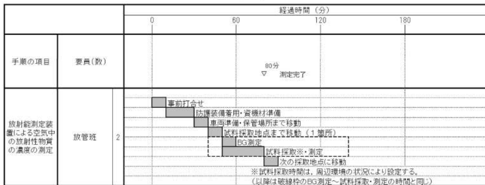
第1.17.9図 放射能測定装置による空気中の放射性物質の濃度の測定 タイムチャート
