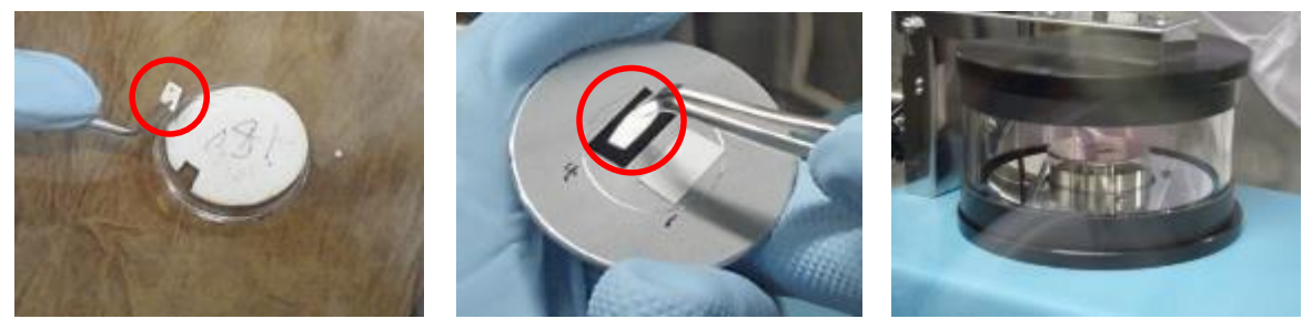
1. スミアろ紙の一部を切り出す 2. 粒子をカーボンテープに付着 3. 表面に金蒸着
