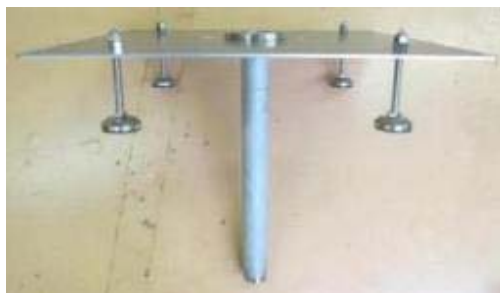
写真 3.1.2-1 J-MOX における AVIS 測定用グローブボックス底部を模擬した治具
