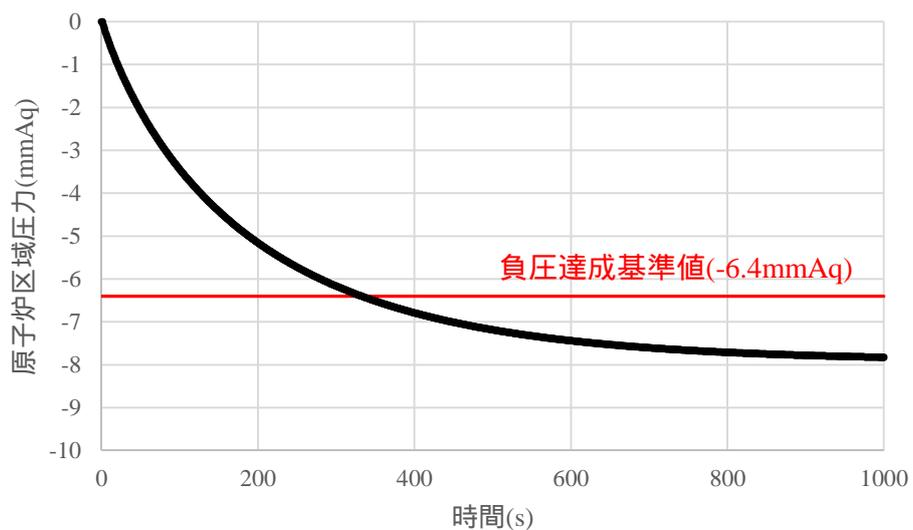
図2 原子炉区域圧力の時間変化
