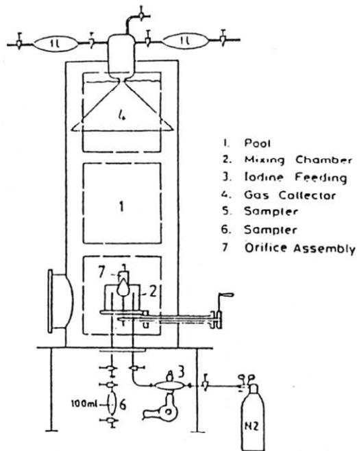
図 16 - 3 POSEIDON 実験体系
