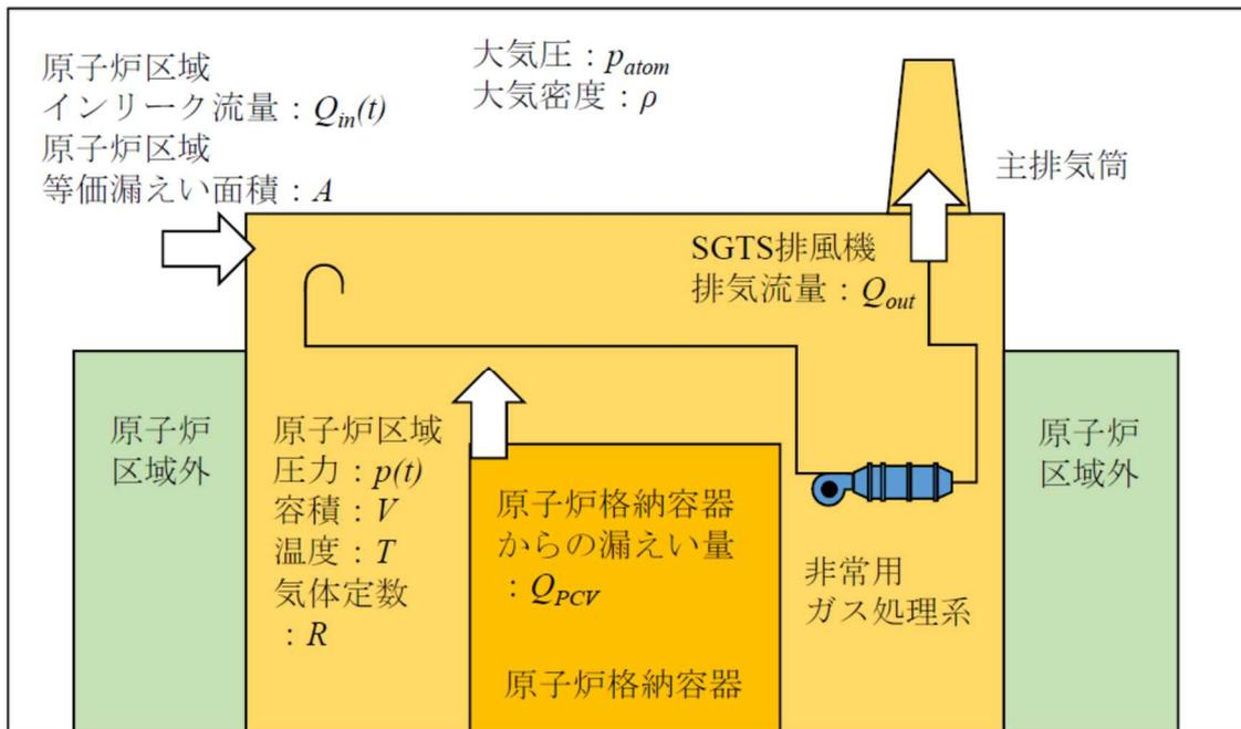
図1 原子炉区域の圧力評価モデル
