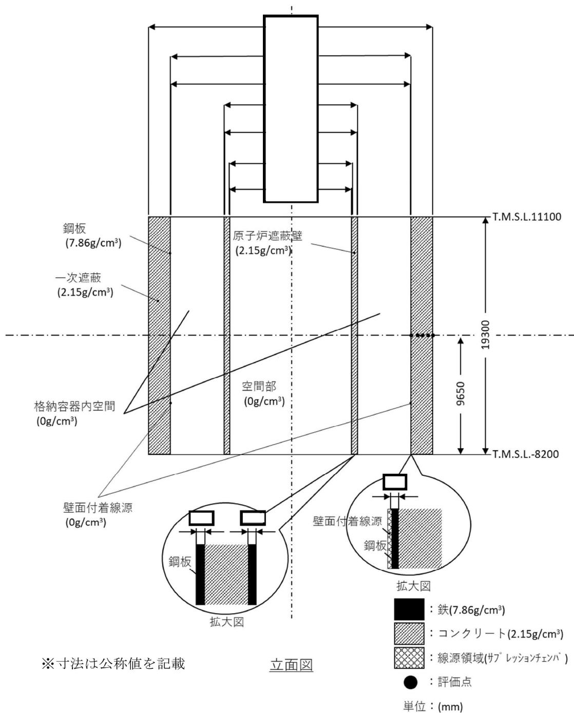
図 29 - 2 評価に使用した計算モデル及び評価点 (W/W, 壁面付着線源) (4/4)
