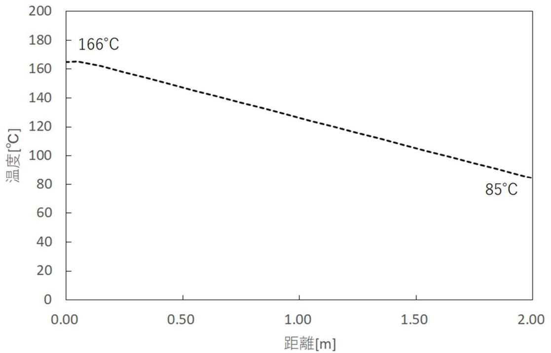
図 29 - 3 一次遮蔽壁コンクリート内側表面からの距離における温度分布 上部 D/W (1/2)
