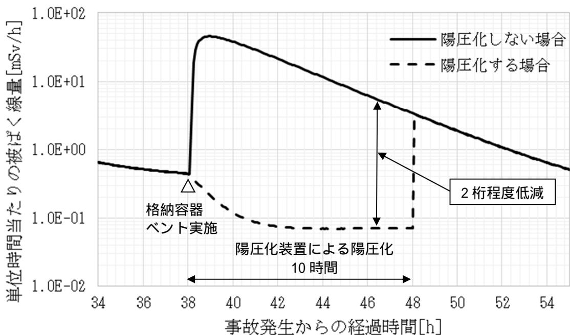
図20 - 1 中央制御室待避室内の単位時間当たりの被ばく線量
