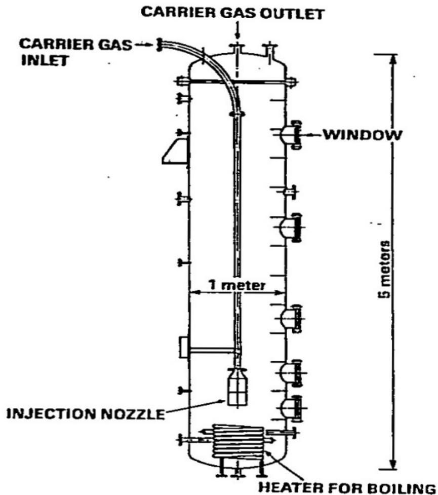
図 14 - 3 試験装置の概要
