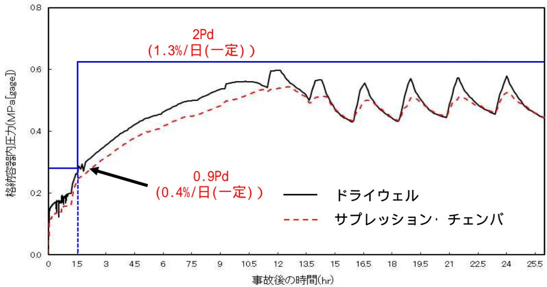
図 13 - 1 原子炉格納容器圧力と漏えい率の時間変化
