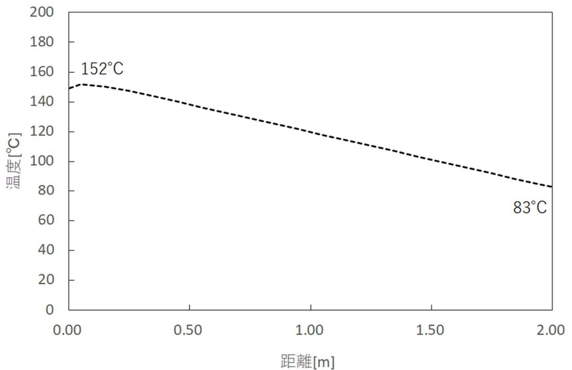
図 29 - 3 一次遮蔽壁コンクリート内側表面からの距離における温度分布 W/W (2/2)
