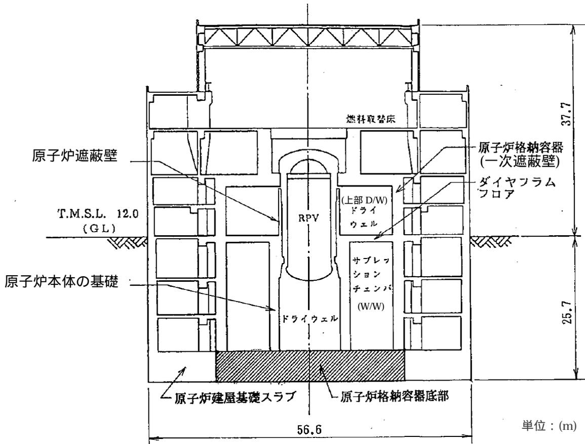
図 29 - 1 原子炉格納容器の立面図
