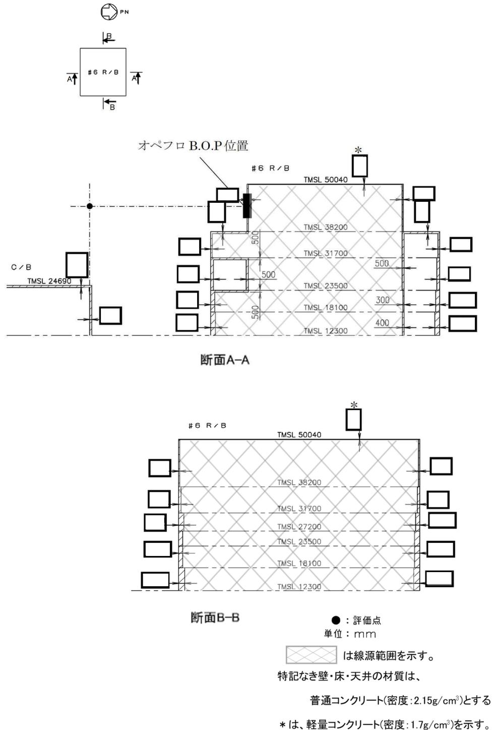
図 27 - 2 直接ガンマ線の評価モデル (2/2)
