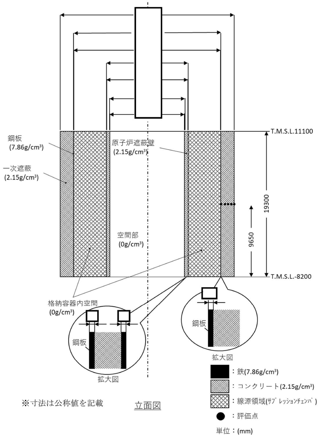
図 29 - 2 評価に使用した計算モデル及び評価点 (W/W, 気相部空間線源) (3/4)
