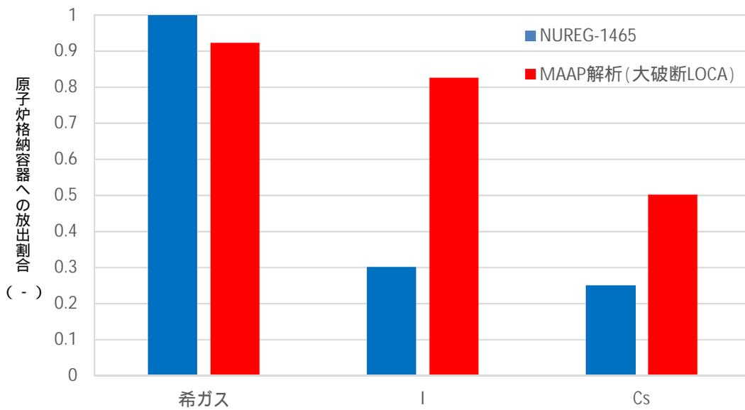
図 19 - 1 原子炉格納容器内への放出割合の比較
