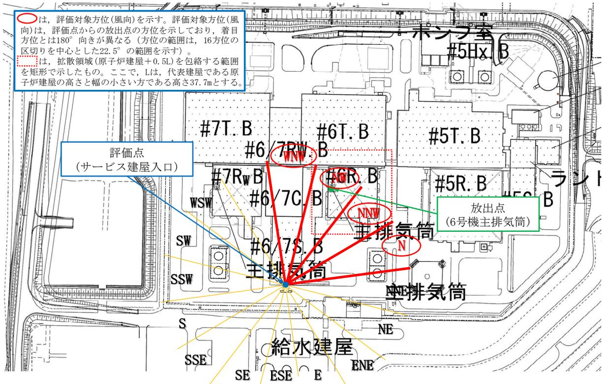
図 4-10 原子炉冷却材喪失時の入退域時の評価風向（サービス建屋入口）（設計基準事故時）
