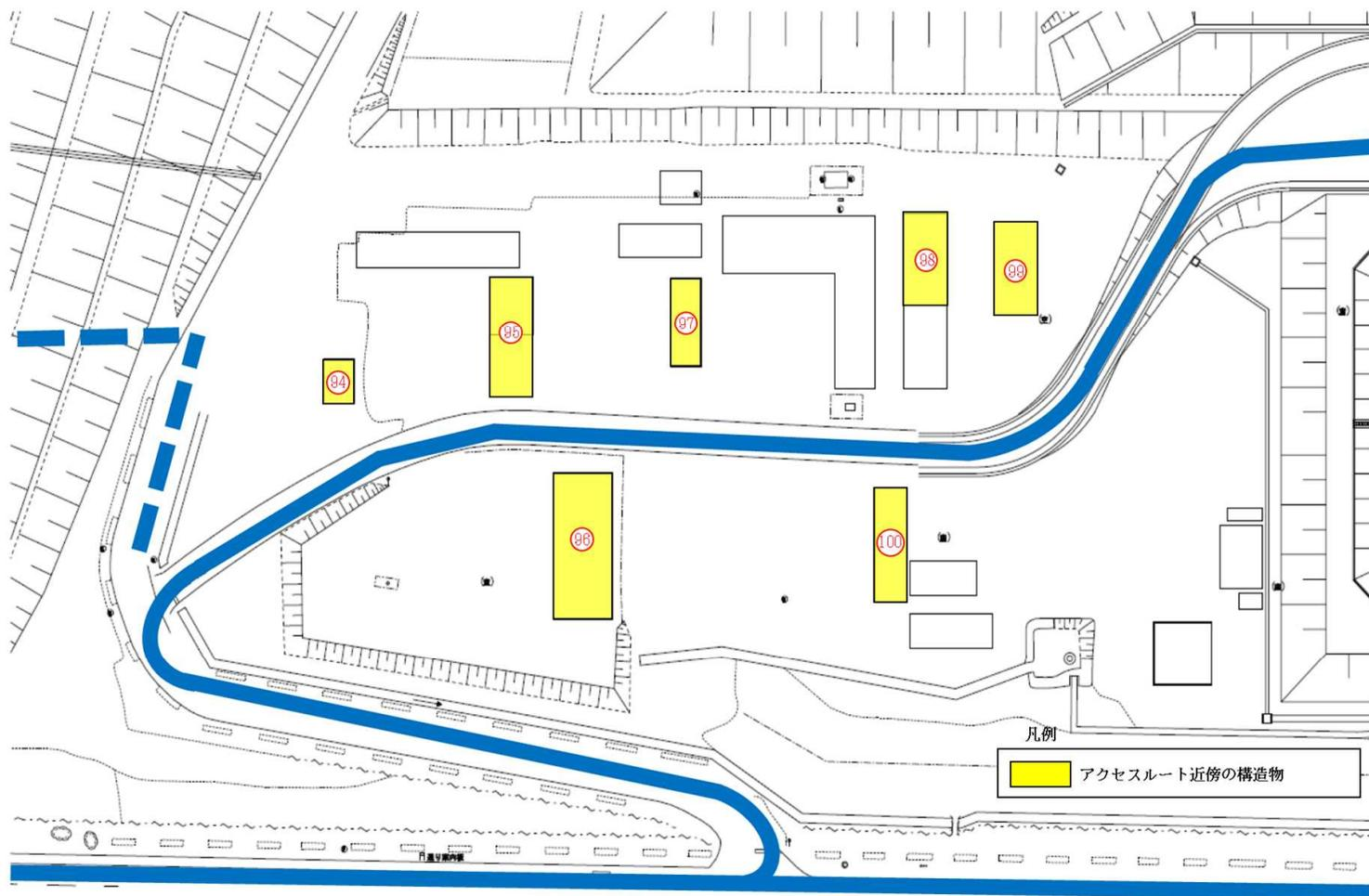
図7-9 屋外アクセスルートの周辺構造物（企業棟詳細図）
