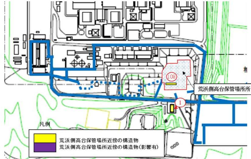
図 7-12 建屋倒壊時の保管場所への影響評価結果（荒浜側高台保管場所）
