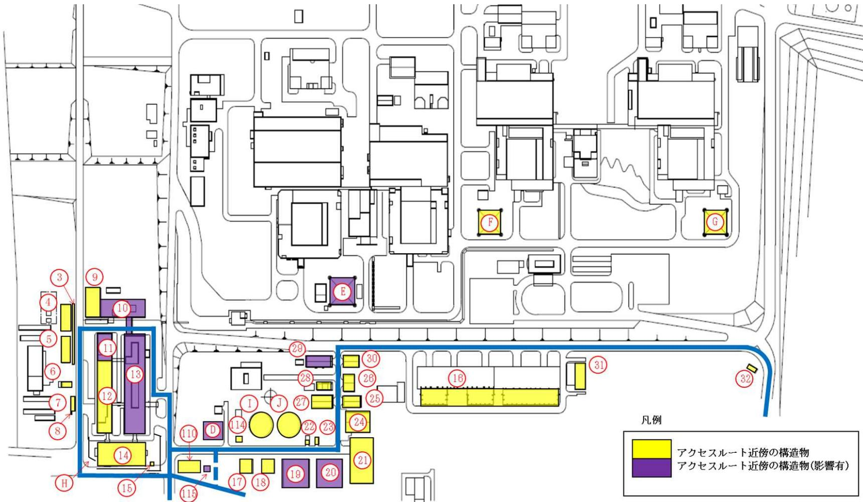
図 7-16 建屋倒壊時の屋外アクセスルートへの影響評価結果（荒浜側詳細図）
