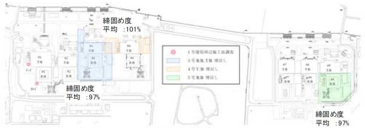
埋戻土の締固め度 (建屋周辺)
