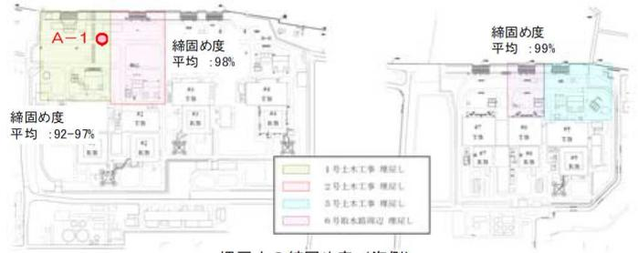
埋戻土の締固め度 (海側)
