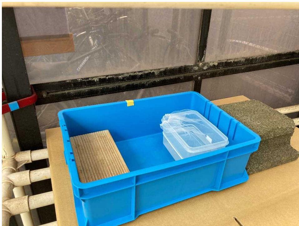
図 2-2 パッシブ法による大気中二酸化炭素の捕集風景
